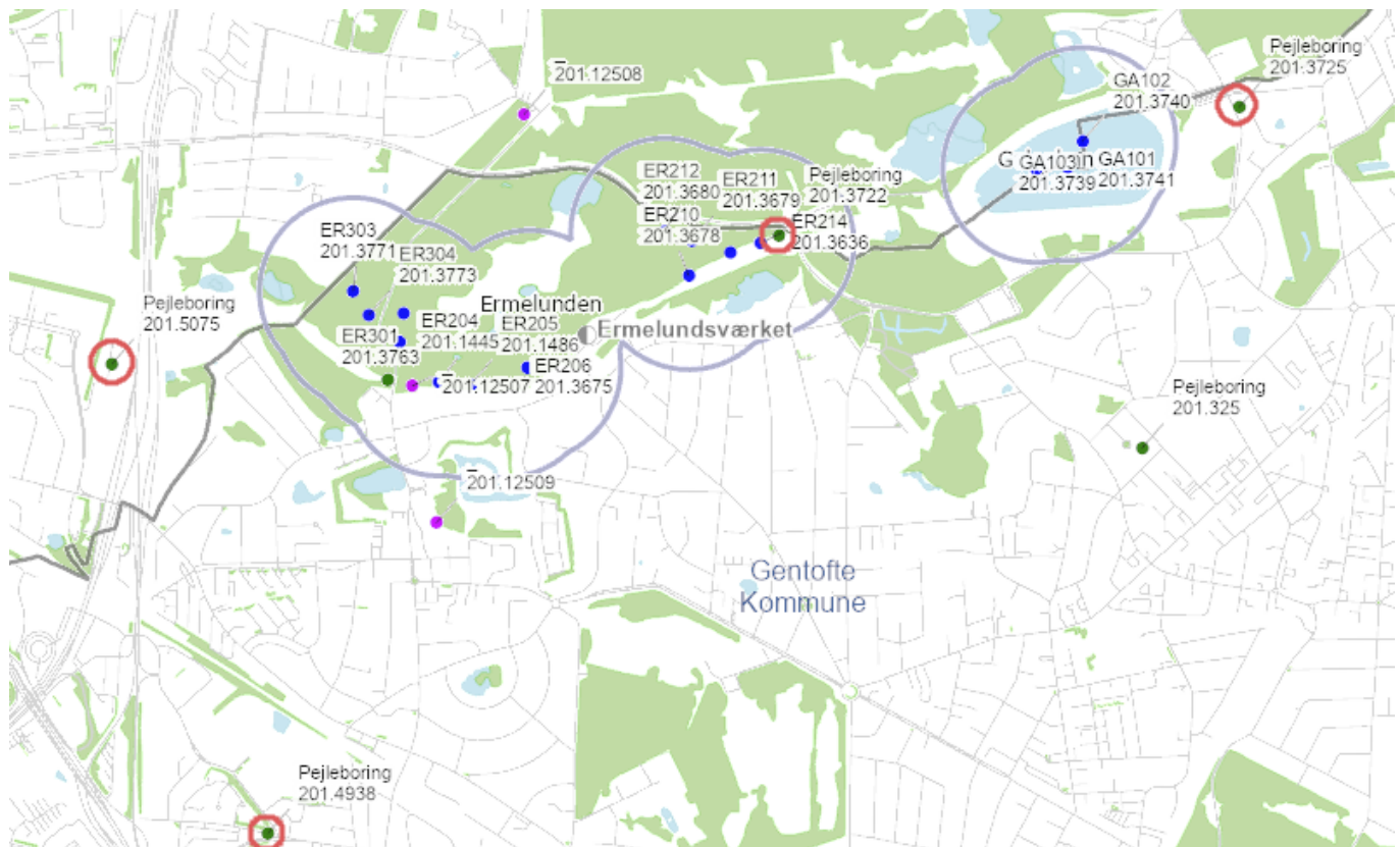
Figur 3: Indvindingsboringer (blå), pejleboringer (grøn) og monitoringsboringer (lilla) til Ermelunden og Galopbanen kildepladser. De udvalgte pejleboringer er markeret med en rød cirkel.
